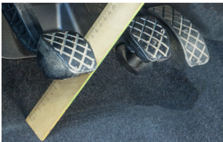
Fig. 1: Após a substituição da embraiagem, o curso livre do pedal deve ser ajustado.
