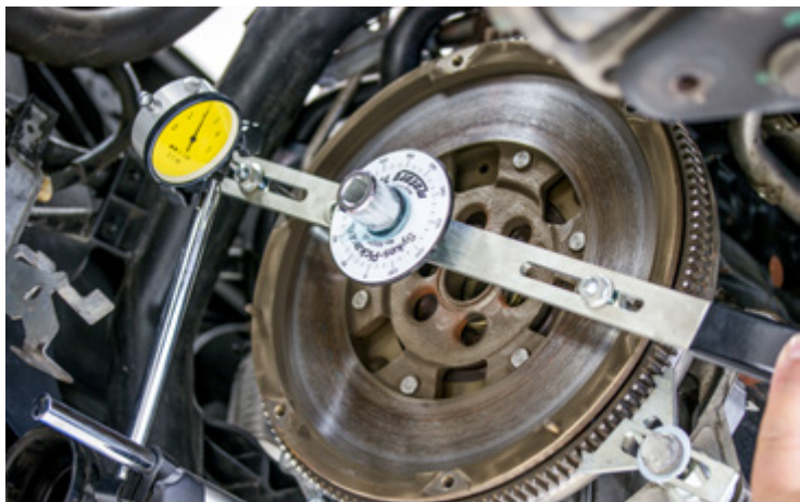
Ferramenta de verificação do volante bimatassa, n.º de artigo: 400 0080 10
