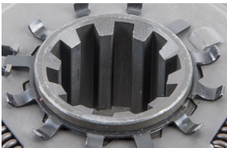
Fig. 2: Os estriados fosfatados devem ser lubrificados
