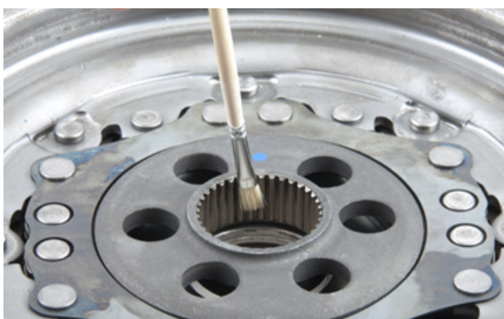
Fig. 1: O estriado interno do ZMS deve lubrificar-se ligeiramente após cada reparação
