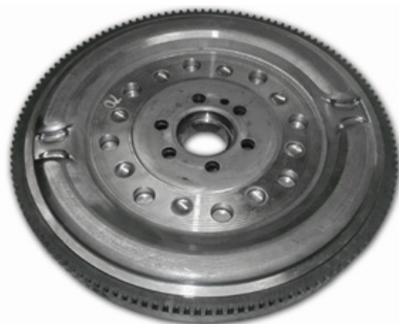
Figura 2: Volante bimassa da SACHS sem rebordo no raio exterior
