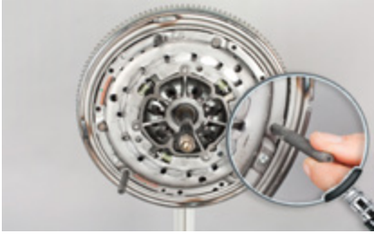
Fig. 5: Aparafusar manualmente o espigão da ferramenta SAC até encontrar uma primeira resistência. Não utilizar nenhuma ferramenta.
