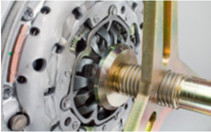
Fig. 8: Tirar a pressão do diafragma afrouxando o fuso da ferramenta SAC e retirá-la do veículo.
