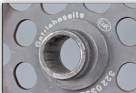
Fig. 2: Perfil do mancal danificado
