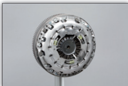
Fig. 7: Coloque o prato de pressão da embraiagem e os parafusos, e aperte com o binário de aperto recomendado pelo fabricante do veículo.
