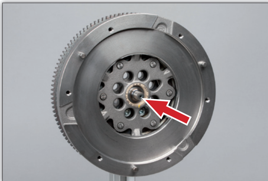
Fig. 1: Espigão guia do volante bimassa 415 0377 10
