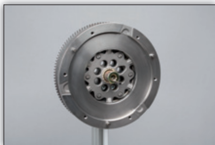
Fig. 4: Coloque a chumaceira de centragem antes de montar a embraiagem (preste atenção ao parafuso).
