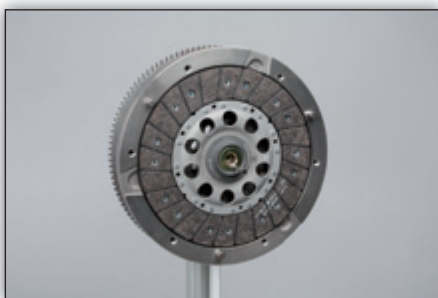
Fig. 5: Coloque o disco de embraiagem.
