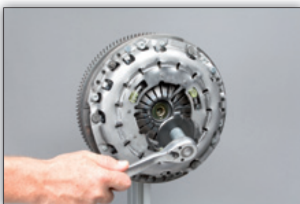
Fig. 8: Desenrosque e retire a peça de bloqueio com a ferramenta adequada. Daí em diante não será necessária.
