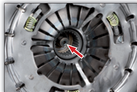
Fig. 2: 415 0377 10 com a embraiagem montada (SAC)
