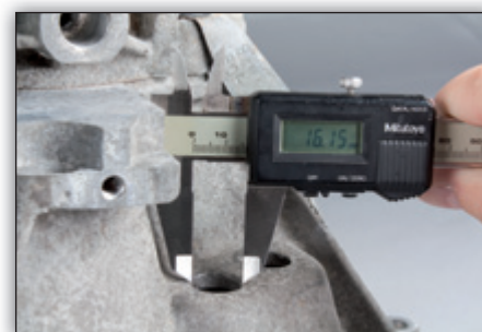
Fig. 2: Se o diâmetro for inferior a 21mm, os orifícios devem ser alargados com uma broca, até atingirem um mínimo de 21 mm e um máximo de 24 mm.
