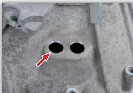
Fig. 6: Eliminação das rebarbas e limpeza.
