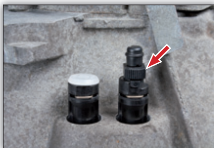
Fig. 8: O bocal de purga deve poder ser aberto à mão ou com uma chave de maxilas ajustáveis (largura da chave: 13)
