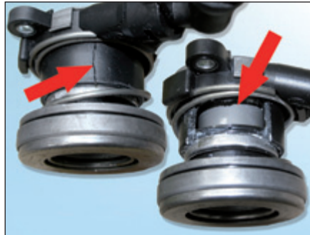
Fig. 5: Rolamento hidráulico danificado por uma instalação incorrecta
