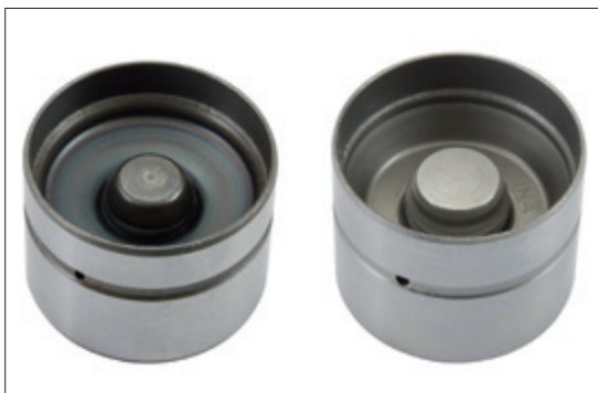
Figura 2: tucho hidráulico de acionamento direto, versão anterior (esquerda) / nova versão (direita)
