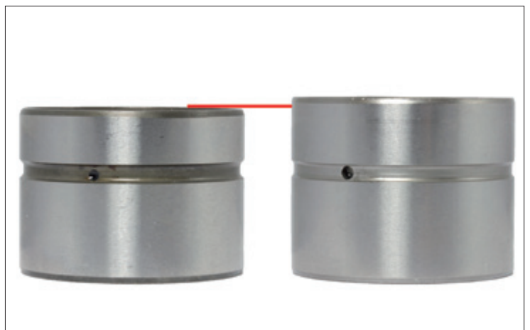
Figura 1: Tucho hidráulico de acionamento direto, versão anterior (esquerda) / nova versão (direita)
